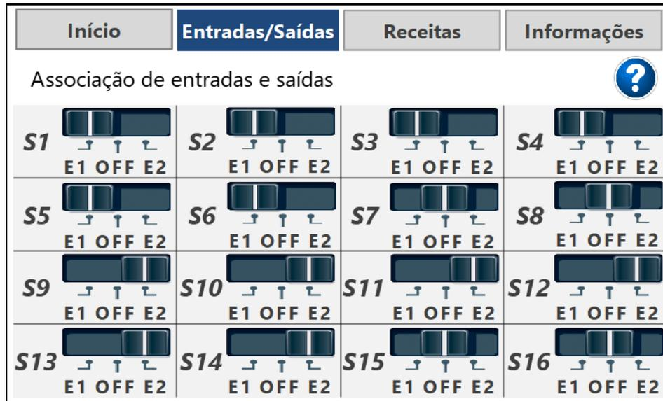
Cada saída pode ser configurada para permanecer sempre desligada ou ser acionada após estímulo do sinal de entrada E1 ou E2, conforme a receita. Seguem as configurações possíveis:
